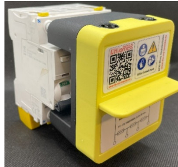
Bild 5: korrekte Positionierung der RCD-Riso Messbrücke
